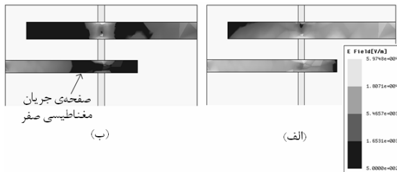
شکل ۴: توزیع (اندازه‌ی) میدان الکتریکی در داخل شکاف (بدون زائده‌ی T شکل) در: (الف) فرکانس تشدید اصلی شکاف کوچکتر: 1620MHz ؛ (ب) فرکانس تشدید ناشی از اتصال کوتاه کاذب: 2200MHz (نمای پشتی آنتن)
